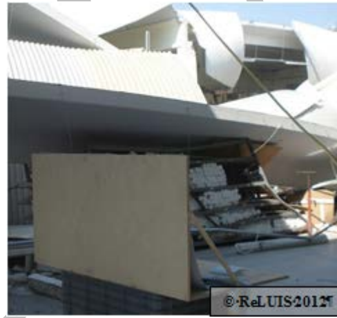
Figura 65 – Collasso scaffalature e conseguente perdita di contenuto
